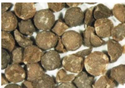
Проба после сжатия при 6000 psi и после обжига при 800°C (без замачивания в нефти)
