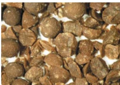
Проба после краш-теста при давлении 10000 psi (проппант после сжатия при 6000 psi, замачивания в нефти и после обжига при 800°C)
